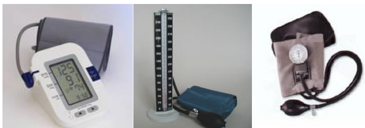
شکل ۲: انواع دستگاه های فشارسنج (عقربه ای، جیوه ای و دیجیتالی)
